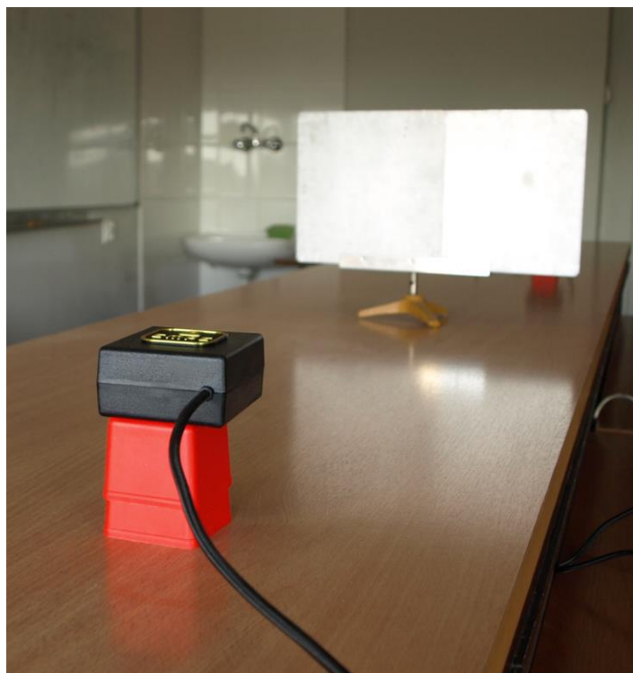
Rysunek 2.– wykres wykonany przez sensor podczas warsztatów w UKEN, nauczyciel trzymając nieruchomo sensor EMPE pracujący w trybie komunikacji bezprzewodowej, rejestruje zmiany swojego położenia względem ściany. Możliwy jest pomiar w przedziale do 0,3 do 50 metrów.
