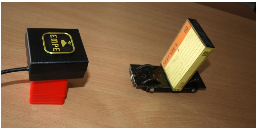
Rys. Przykład użycia sensora EMPE oraz wózka z płaską ścianką, w celu poprawy precyzji pomiaru zmian odległości od sensora.
